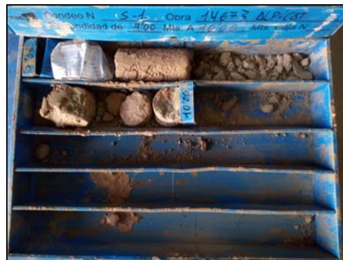
CAIXA N°4. DE 9.00 A 10.00 m. FI DE SONDEIG
